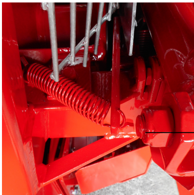
→ Bremshebel mit Zugfeder gespannt
