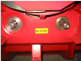
Eine 2. Seilgeschwindigkeit (Untersetzungsgetriebe, - 40%) kann entweder sofort bei der Bestellung eingebaut, aber auch jederzeit einfach nachgerüstet werden. Mehr Kraft vom Trägerfahrzeug, um 40% verminderte Einzugsgeschwindigkeit.
