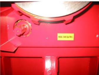
In der Praxis ist die Höhe des Antriebes und die zentrale **Position des Zapfwellenstummels** wichtig. Bei starkem Zuzug wird die Winde in den Boden hineingezogen. Sind der Antrieb, Bremse, Kupplung,... zu weit unten, verschmutzen diese dadurch schnell und werden unwirksam.
