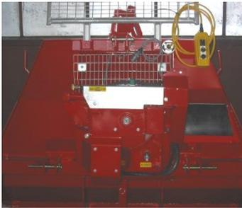
MAXWALD bietet **ELEKTROHYDRAULISCH GESTEUERTE SEILWINDEN** mit hydraulischer **Eigenölversorgung**, (d.h. Pumpe und Tank auf der Winde) an. Diese Steuerung schaltet äußerst präzise (kein Druckaufbau, kein Nachlaufen!). Die Eigenölversorgung arbeitet nie im Überdruckbereich. Dadurch wird das Hydrauliköl nicht warm und die Steuerungskomponenten werden geschont.
