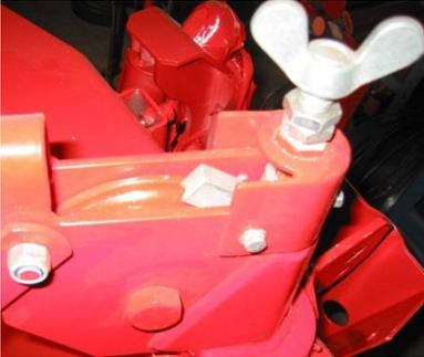
Für die Haltbarkeit des Zugseiles ist es wichtig, dass das Seil möglichst gespannt auf die Trommel gewickelt wird und auch kompakt auf der Trommel bleibt. Hier bietet MAXWALD beispielsweise eine **mechanische Seileinlaufbremse** an. Diese bewirkt eine Vorspannung zwischen Seileinlauf und Seiltrommel.
