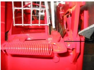
Weiters sind alle MAXWALD Seilwinden serienmäßig mit einer ebenfalls wartungsfreien und selbstjustierenden **Trommelnachlaufbremse** ausgerüstet.
