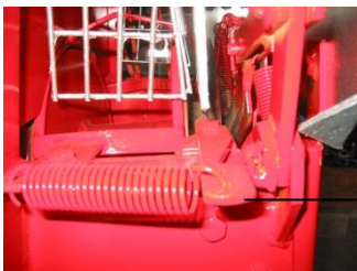
→ Bremshebel mit Zugfeder
