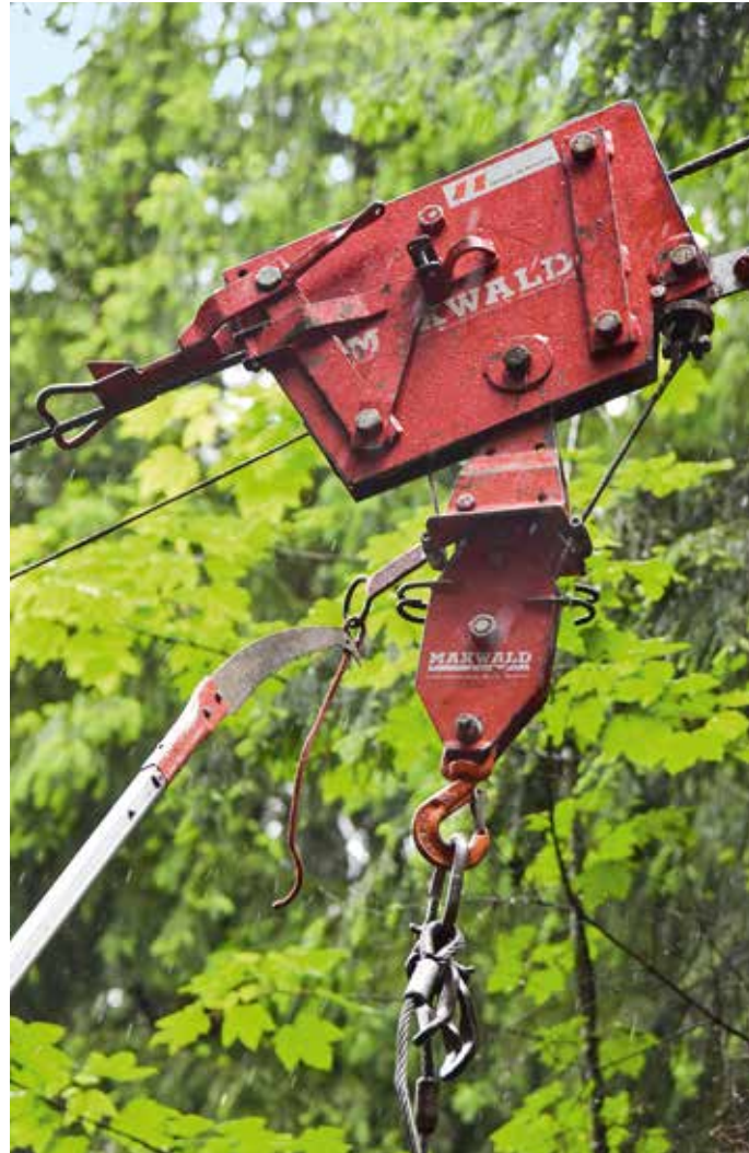
▷ Eine Klinke verriegelt den Lasthaken im Laufwagen. Sie lässt sich per Gestänge lösen. Dann kann sich der Haken wieder nach unten absenken.
