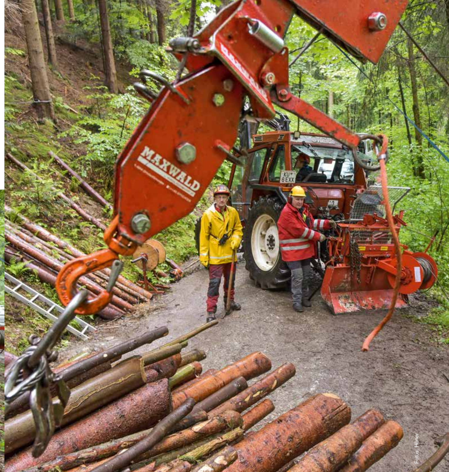
△ Optimaler Aufbau der Anlage: Traktor und Winde stehen seitlich in direkter Nähe. Die Waldstraße dient als Polterplatz.
