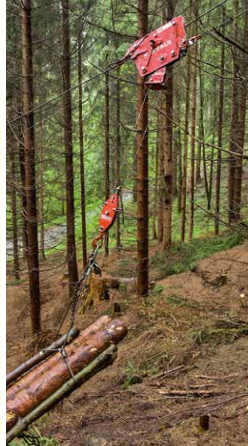
△ Das Seil zieht den Haken nach oben, bis er im Laufwagen verriegelt.
