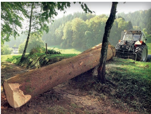
Il Maxwald M2000 Premium può essere impiegato anche per lo strascico diretto di carichi molto rilevanti
