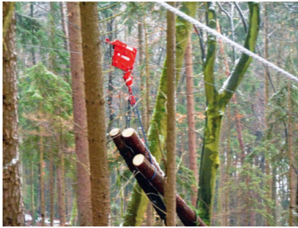
Der Laufwagen mit angehängter Last wird mithilfe des Zugseils am Tragseil bergauf gezogen.
