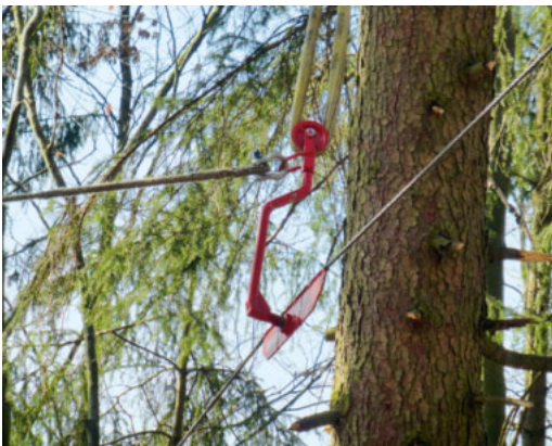
Eine überfahrbare Tragseilstütze sichert an Geländekanten oder bei größeren Distanzen den Mindestabstand zum Boden.
