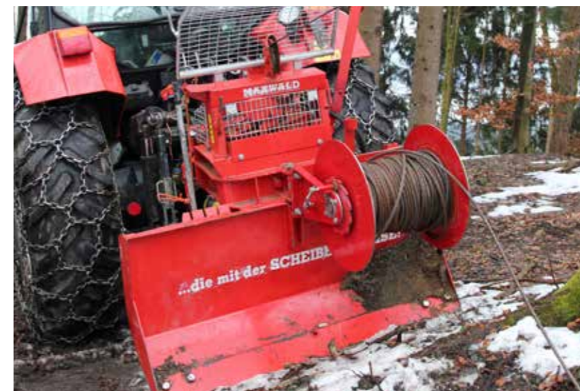
Die Rückwinde transportiert das Trage-seil und das Zugseil.
