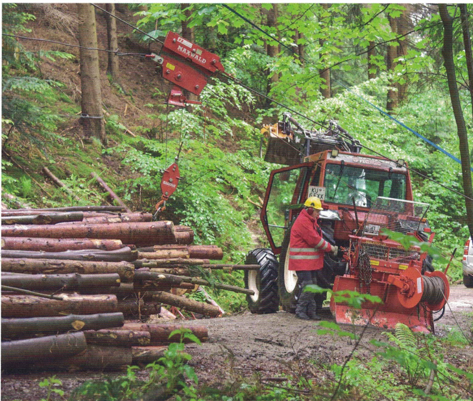
△ Max Feichtner bevorzugt die manuelle Steuerung der Winde. Sie lässt sich feinfühlinger regeln.
