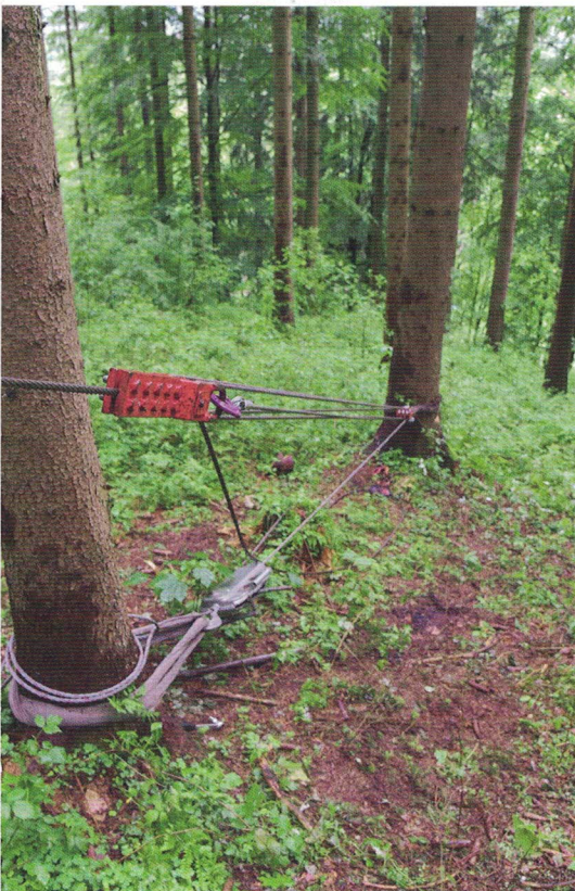
△ Hier das System zum Abspannen des Mastbaums. Ein Seilzug plus Flaschenzug spannt das Seil.
