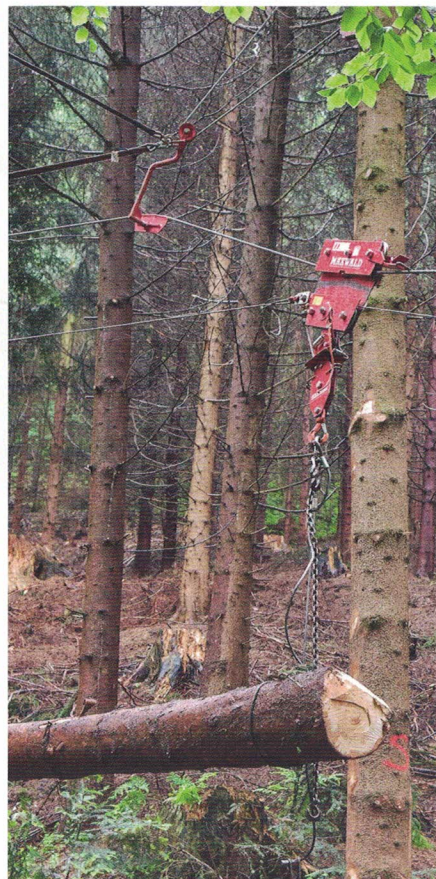
△ Hier das System zum Abspannen des Mastbaums. Ein Seilzug plus Flaschenzug spannt das Seil.
